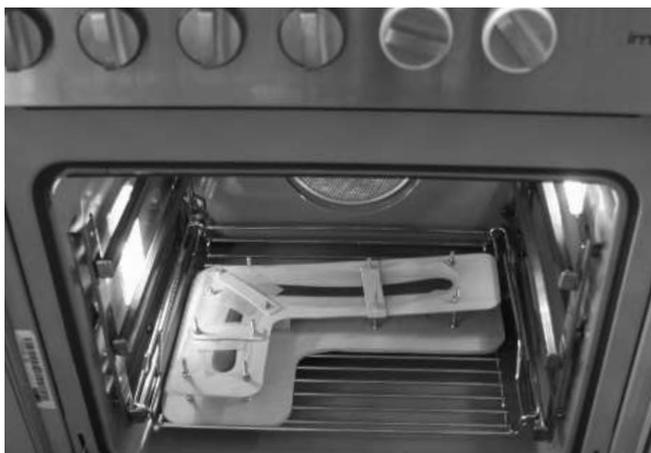
Natürlich kann man einen Bumerang durch einfaches kaltes Biegen tunen. Erfahrungsgemäß beschleunigt Wärme das ganze jedoch und macht es dauerhaft. Gefährlich wird es, wenn der Bumerang zu warm wird. Vor allem bei CFK erreicht man irgendwann den Schmelzpunkt des Harzes und der Bumerang knickt wie eine Lakritzstange. Hier zeigt sich der Vorteil unseres Brettes. Die Biegung ist vorgegeben und selbst wenn das Harz weich wird, entstehen keine Extreme.
